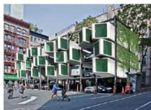
**Description :** Ce projet réutilise les espaces de parking de New York. La structure métallique sert de support pour le logement modulaire construit en plastique recyclé. Les modules sont mis en place par des « monte-voitures ». Design par Eugene Lubomir.
