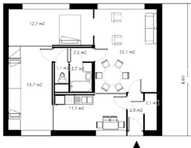
AMSTERDAM, Fondation Lieven de Key, 1987 Architecte Duinker et Van der Tor T3 de 74 m 2 Double circulation et cloisons coulissantes, séjour en retrait Doct. M. PATTOU (droits réservés)
